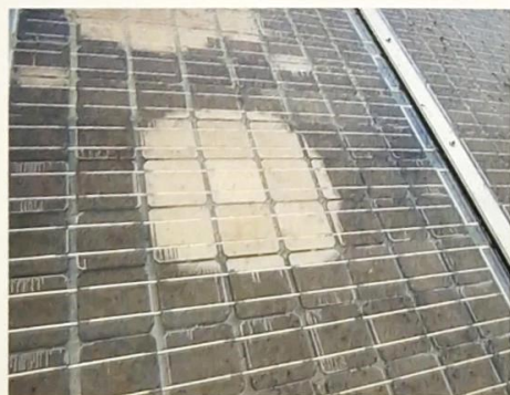
5 Semitransparente Module nach über 20 Jahren Einsatz
