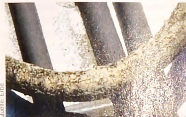
12 Weitere H07RNF-Leitung nach 20 Jahren Einsatz im Dachbereich
