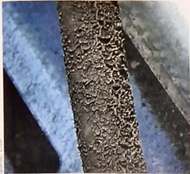
11 H07RNF-Leitung nach 20 Jahren Einsatz im Dachbereich
